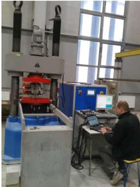
Badania modułu sprężystości walcowych próbek betonu
