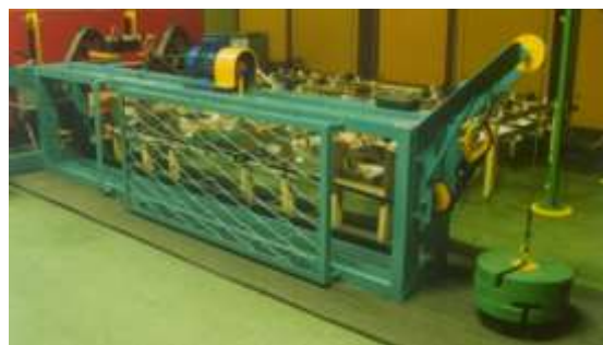
stanowisko do badania wpływu drgań mechanicznych (a station for testing the influence of mechanical vibrations)
