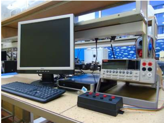
Osprzęt do komputerowego zbierania i przetwarzania odpowiedzi gazowej testowych struktur sensorowych poddanych oddziaływaniu kontrolowanej atmosfery gazów toksycznych lub wybuchowych
