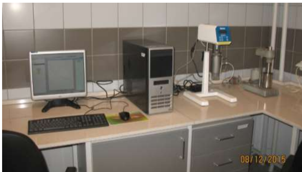
Stanowisko do wyznaczenia parametrów reologicznych hydromieszanin (Stand for determining rheological parameters of hydromixtures)
