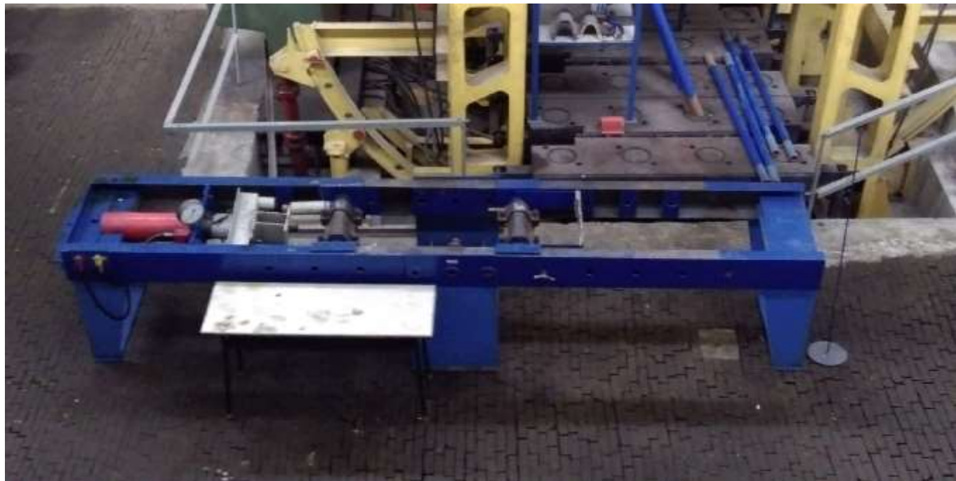
Stanowisko do badań rozpór Station for sprag testing
