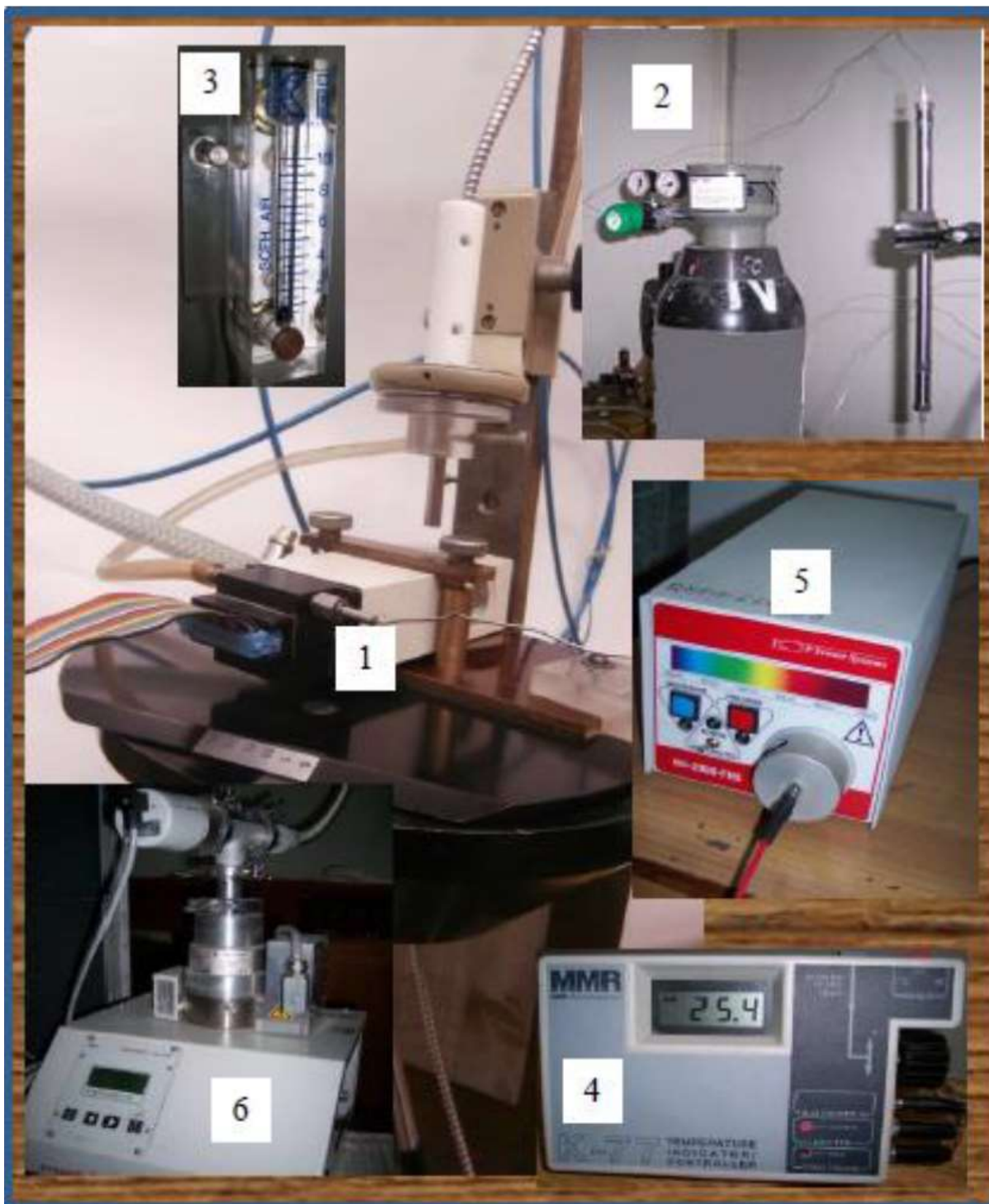
Rys. 2. Zdjęcie stanowiska pomiarowego do badania widm współczynników transmisji i odbicia optycznego przy prostym padaniu światła w różnych temperaturach z zakresu od T = 80\text{ K} do T = 330\text{ K} (1 – komora próżniowa z mikrochłodziarką, 2 – butla z azotem gazowym oraz filtr, 3 – przepływomierz, 4 – kontroler temperatury, 5 – źródło światła, 6 – pompa próżniowa)
