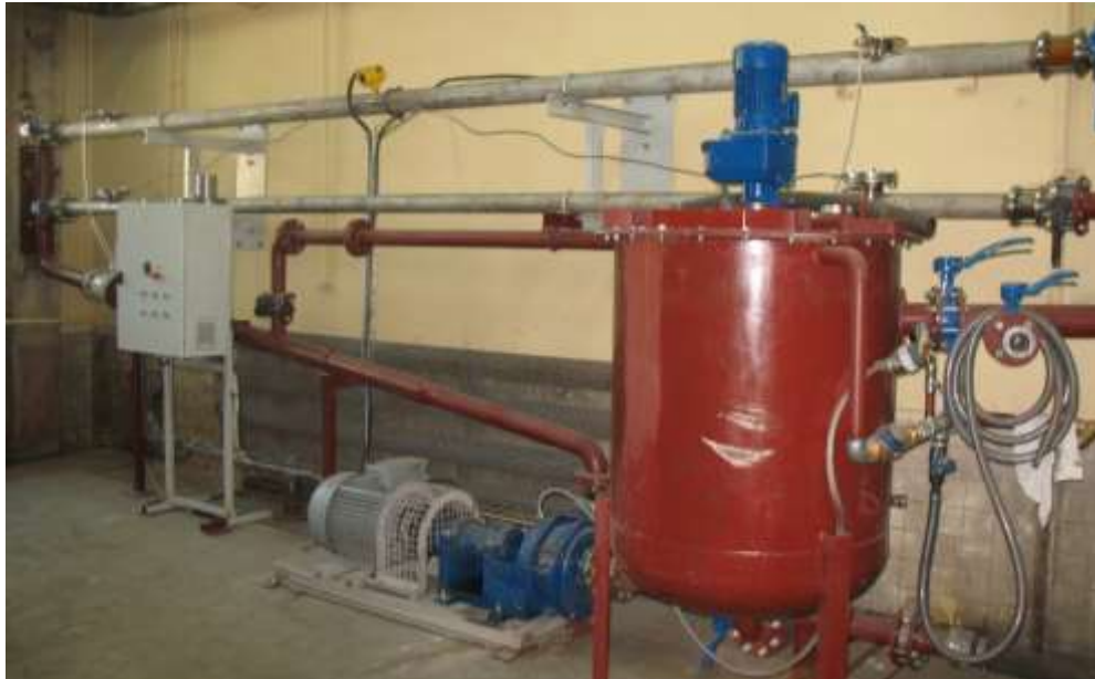
Półprzemysłowe stanowisko badawczo-pomiarowe do wyznaczenia strat energetycznych hydromieszanin drobnofrakcyjnych (Semi-industrial test and measurement station for determination energy losses of fine-grained hydromixtures)
