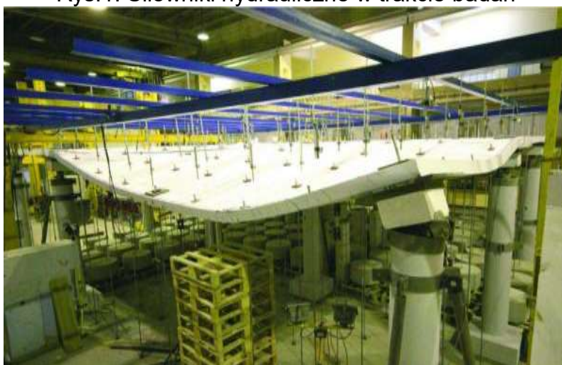
Rys. 2. Badania ustroju płytowo-słupowego
