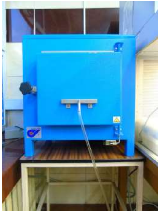
Piec komorowy do obróbki termicznej szkliv nakładanych metodą spin-on i spray-on
