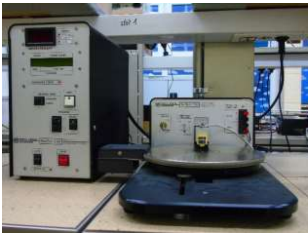
Sonda czterostrzowa z układem pomiarowym do wyznaczania rezystancji powierzchniowej krzemowych warstw dyfuzyjnych
