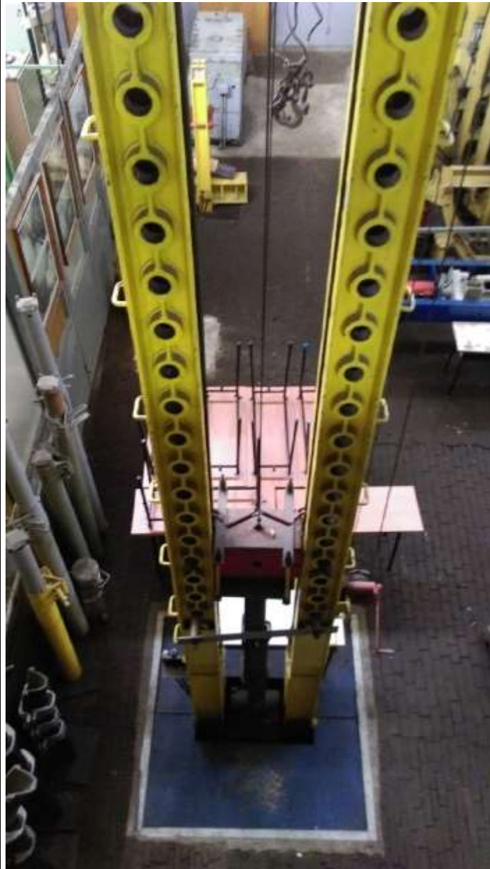
Stanowisko do badania zacisków górniczych przy osiowym obciążeniu Station for axial load tests conducted on minind clamps.
