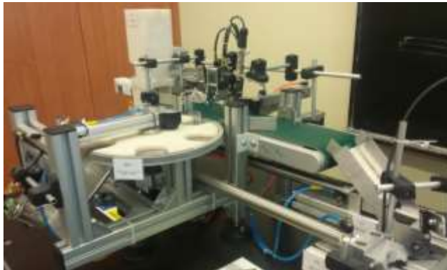
Rys. 2. Moduł wejściowy, transportowy i magazyn karuzelowy
