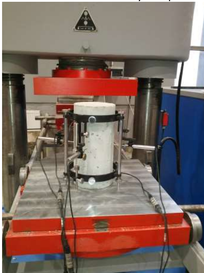
Badania modułu sprężystości walcowych próbek betonu Test of elastic modulus of concrete cylinder specimens
