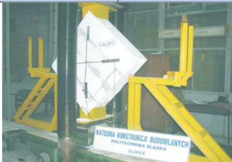
Rys. 1. Prasa 6000 kN podczas badań muru na ukośne ściskanie
