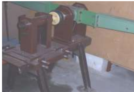
Stanowisko laboratoryjne do badań statycznych sprzęgieł podatnych
