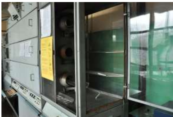
Piec komorowy do wygrzewania i utleniania cienkich warstw sensorycznych
