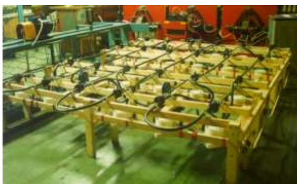
stanowisko do badania zacisków przebijających izolację (test stand for insulation piercing connectors in overhead insulated LV lines)
