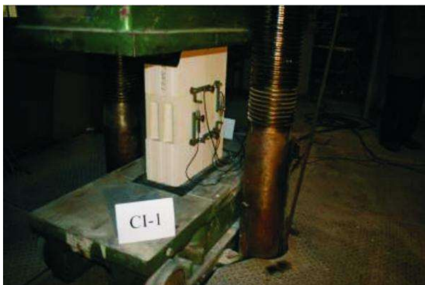
Rys. 2. Badania na ściskanie ścian murowanych
