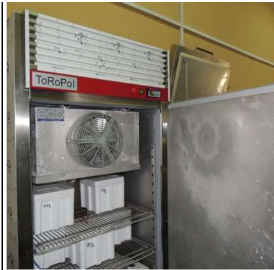
Badanie mrozoodporności w solach odladzających
