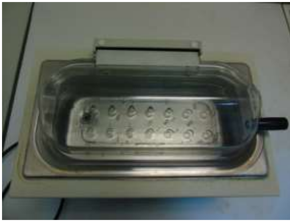
Wnętrze komory do prowadzenia procesu chemicznej metalizacji stopami Ni-P
