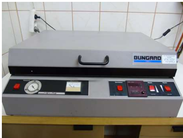
Naświetlarka do obróbki fotochemicznej emulsji światłoczułej wykorzystywanej do selektywnego osadzania cienkich warstw metalicznych
